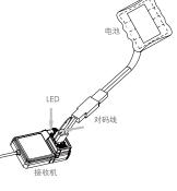
• 此步骤适用于 FS-GT2E 发射机与 FS-A3 的接收机对码,如您使用的是其他接收机,请进入官网查询对 应接收机的使用说明书进行操作。
